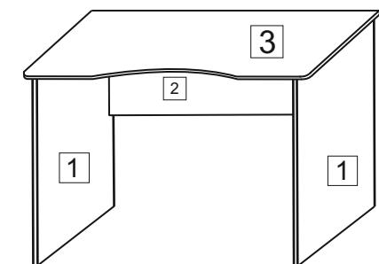
Заднюю стенку [2] закрепить между боковинами [1], столешницу [3] установить на боковины [1] и заднюю стенку [2], последовательно стягивая между собой установленной фурнитурой.
