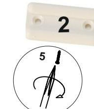
Подпятник 2 установить на боковины 1 закрепив шурупом 5 согласно схеме
