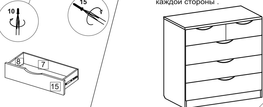
**Внимание:** на боковинах [8] под направляющие 81 нанесены отверстия, которые являются ориентиром центрального расположения направляющих по высоте и могут не совпадать с отверстиями на самой фурнитуре. Направляющие установить в плотную к краю боковины [8] и зафиксировать через овальные отверстия, для возможности регулирования при установке. Сильно не затягивать!!!
